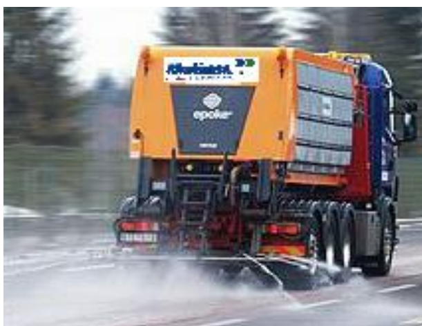
Figura 7. Camión extendedor de salmuera en tratamiento preventivo.
