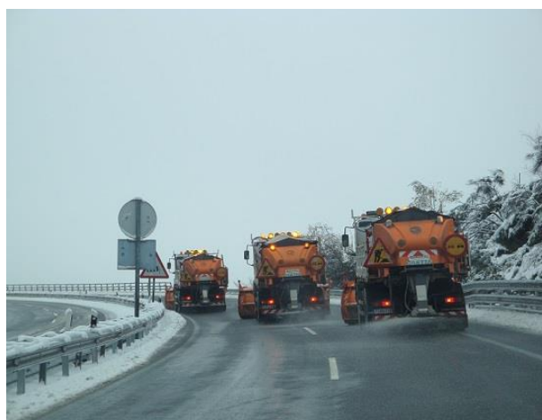
Figura 8. Camiones en tándem extendiendo sal sólida en tratamiento curativo.
